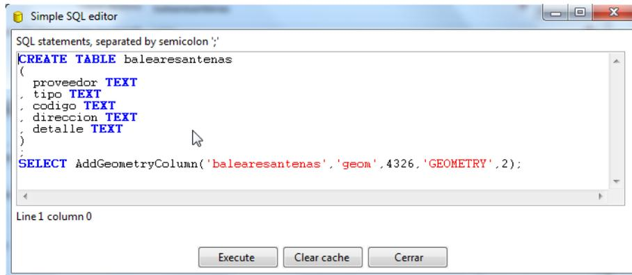
En bases de datos más antiguas para añadir una columna con tipo de datos **geometry** había que usar la función *AddGeometryColumn*. En las versiones más recientes de PostGIS ya no existe esta necesidad y se puede crear el atributo directamente como se ve en la siguiente ilustración con el respectivo resultado.
