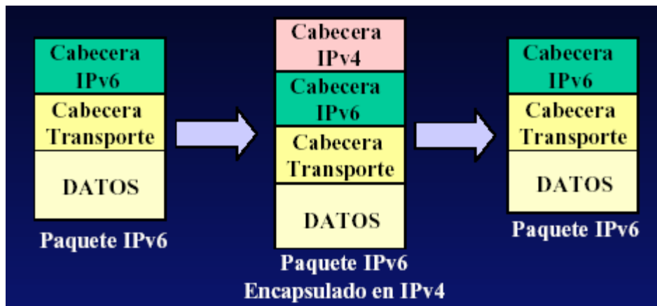
Figura 10. Túnel IPv6 encapsulado en IPv4
